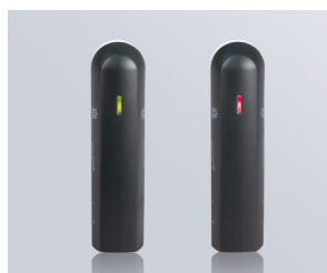
Lade-Anzeige durch zweifarbige Leuchtdiode
